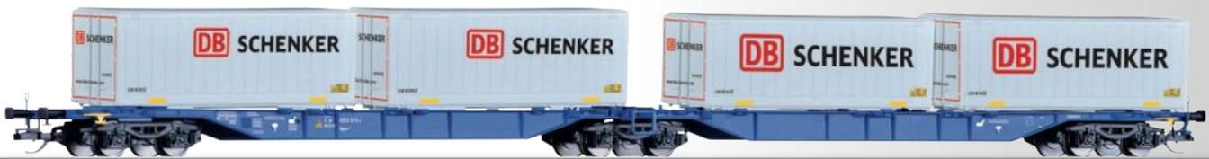
Doppeltragwagen Sggmrs 714 der DB AG, beladen mit vier Wechselbehältern
